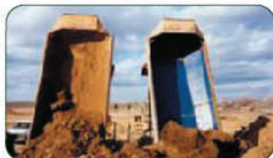
Ulpolen®'in özel bir tipi ile kaplanan damperler sıcak asfalta karşı dayanıklı olup +175°C sıcaklığı kadar üzerine asfalt yapışmadan görev yaparlar.
